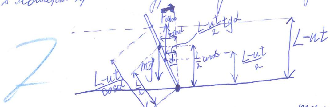
На стержне действуют 2 силы: тяжесть  $mg$  ( $m = LSg$  — масса стержня) и центральная сила (уровень воды) и Архимеда  $F_{\text{арх}}$ . Объем погруженной под воду части стержня равен  $V = \frac{L-ut}{\cos\alpha} S$ , а  $F_{\text{арх}} = VnLg = \frac{L-ut}{\cos\alpha} nSg \cdot mg = LSg$ .
