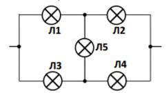
**Комментарий**: Ясно, что ток через Л5 не течет, поэтому  $I_2=I_1$  и  $I_4=I_3$ . Кроме того, напряжение на Л5 равно нулю, поэтому  $U_3=U_1$  и  $U_4=U_2$ . Лампа 4 работает в номинальном режиме, поэтому ее номинальная мощность  $P_4=U_4I_4=U_2I_3=\frac{U_2I_2}{I_1}\frac{U_3I_3}{U_1}=\frac{P_2P_3}{P_1}$ .
