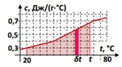
на участке от начальной до конечной температуры жидкости, умноженную на массу жидкости. Как видно, для нагрева жидкости от  $t_1 = 20^{\circ}\mathrm{C}$  до температуры  $40^{\circ}\mathrm{C}$  потребуется количество теплоты  $Q_1 = 500\Gamma \cdot \frac{0.3 + 0.4}{2} \frac{\mathrm{Дж}}{\Gamma \cdot {}^{\circ}\mathrm{C}} \cdot (40 - 20)^{\circ}\mathrm{C} = 3500\mathrm{Дж}$ , что заметно меньше, чем выделится
