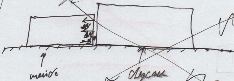
При соударении на границе между телами возникает ударная волна, распространяющаяся по телам со скоростью звука  $\Delta V$ , которая имеет все свойства ударных процессов.
