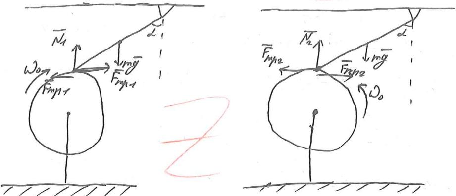
1. Сила реакции опоры в обоих случаях направлена вертикально пл.к. стержень лежит на вспуще торце обода.
